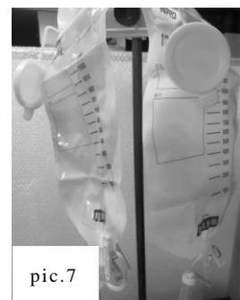
正極表面に純水を注ぎ込む。電池セルを通過した補給液は下方にため置き必要に応じてリサイクルする。
